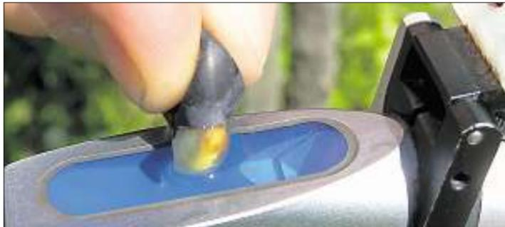
Eine Traube wird über der Glasfläche des Refraktometers ausgedrückt. Danach wird der Zuckergehalt des Safts abgelesen.
